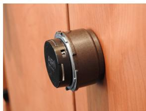
Mit dem Werkzeug in die markierte Vertiefung drücken
